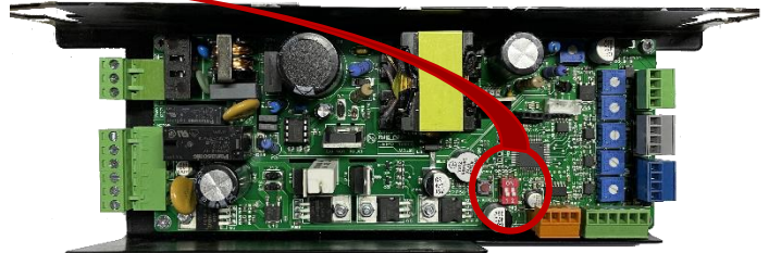
Şekil 10: Switch'in kart üzerindeki konumu ve yakından görünümü.
