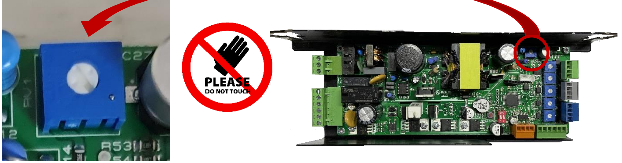
Şekil 13: Güç ayarlama potunun kart üzerindeki konumu ve yakından görüntüsü.
