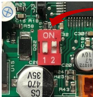
Şekil 10: Switch'in kart üzerindeki konumu ve yakından görünümü.
